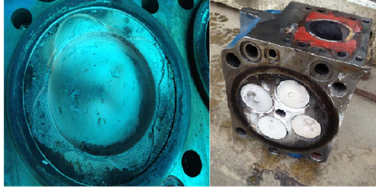
Şekil 1.3: Motor silindir kafası üzerindeki silika depozit birikimi
