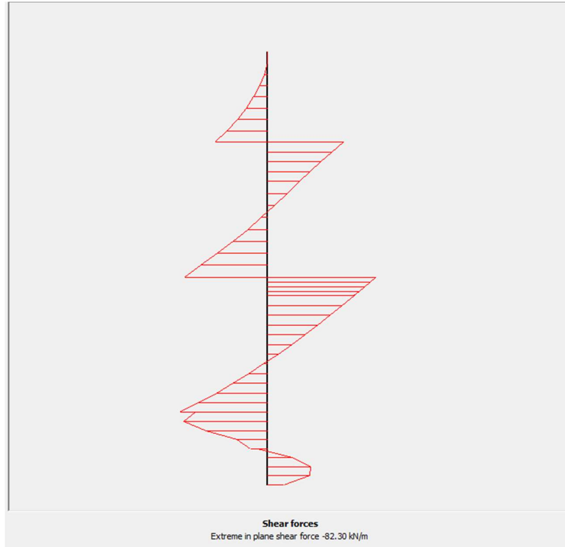
Şekil 9.53: Plaxis programı kesme grafiği (maks:82.30 kN/m)
