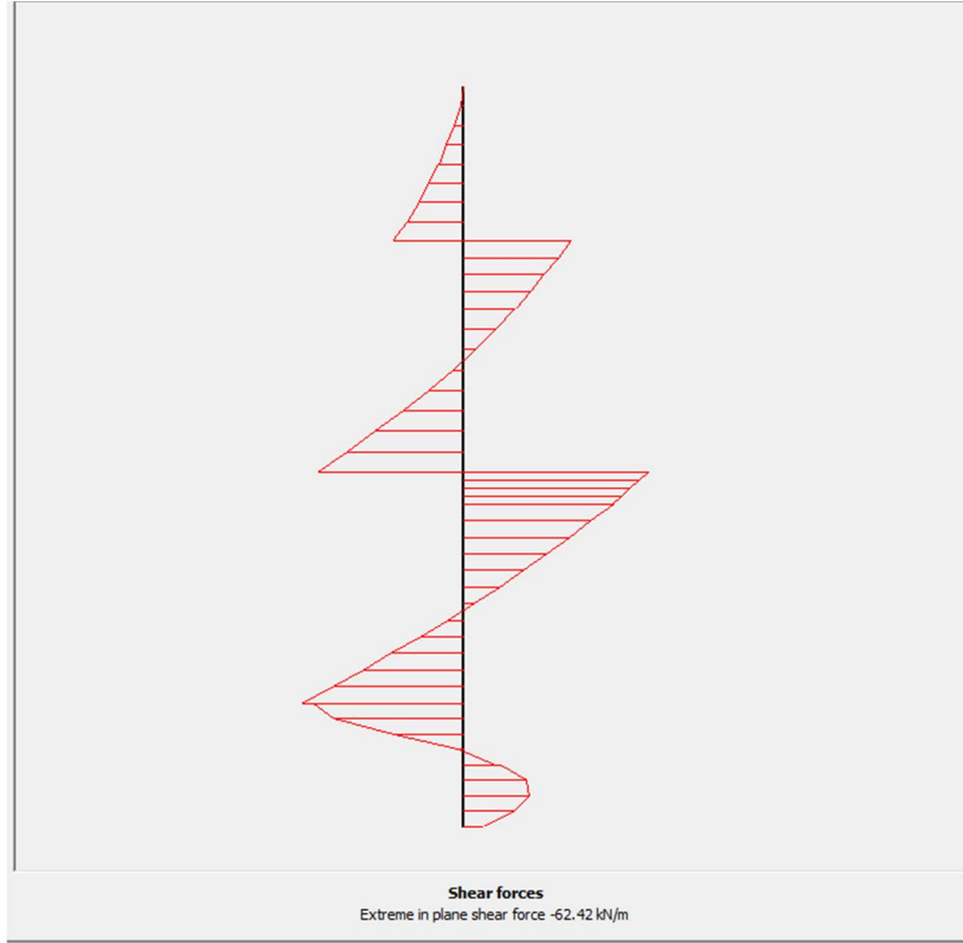
Şekil 9.45: Plaxis programı kesme grafiği (maks:62.50 kN/m)
