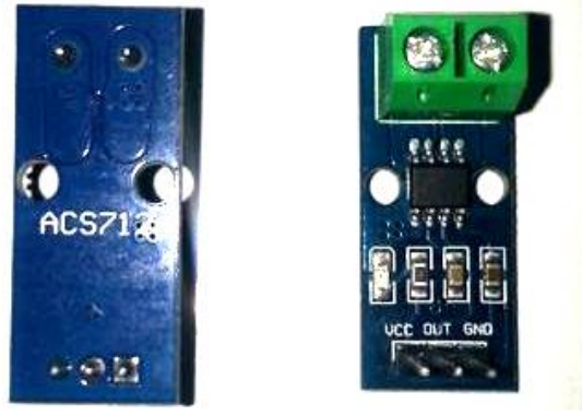
Şekil 4.3: Hall etkisi tabanlı akım sensörü
