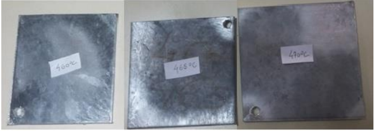
Şekil 4.27: Farklı galvanizleme ocağı sıcaklıklarında daldırılan numune sacların galvaniz kaplama sonrası görünüşleri
