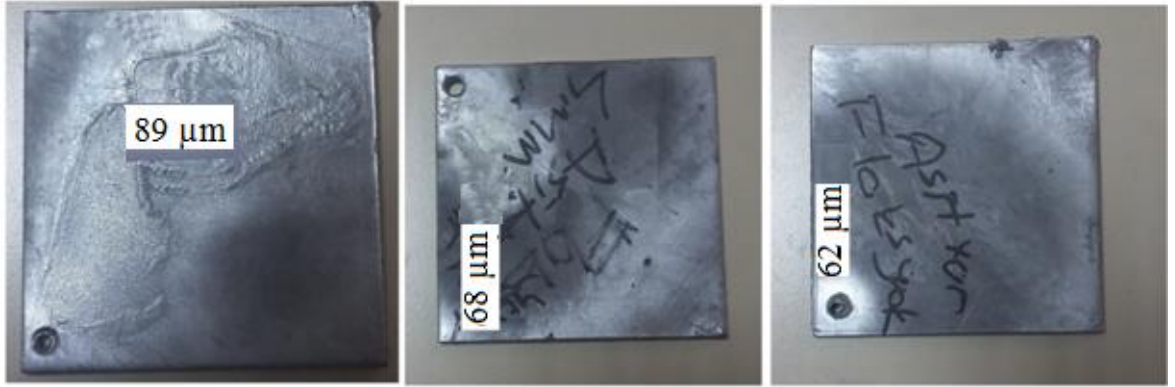
Şekil 4.16: Asit ile temizlenip flux havuzuna daldırılmadan galvaniz kaplanan numune sacların görüntüleri
