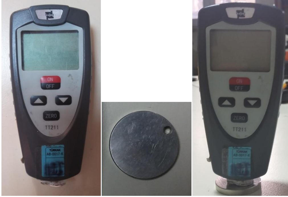
Şekil 3.18: Çinko kaplama kalınlığını ölçmek için kullanılan Teskon TT-211 cihazı ve ölçüm başlangıcında değeri sıfırlama yüzeyi
