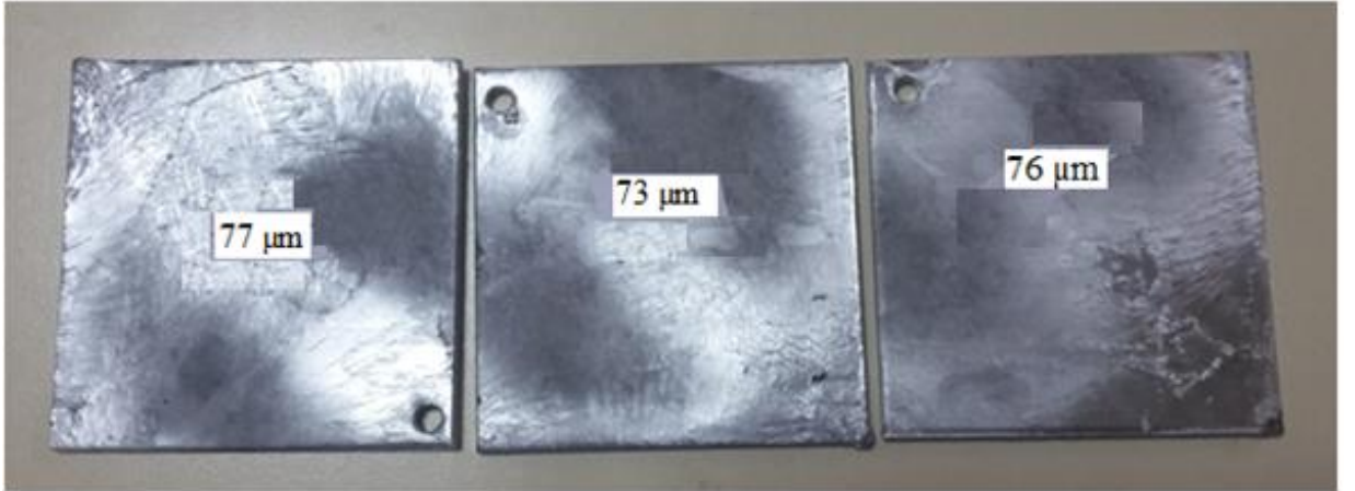
Şekil 4.11: Giriş hızı: 3,8 m/min-çıkış hızı: 3,8 m/min yapıldığında numune sacların galvaniz kaplama sonrası görünümleri
