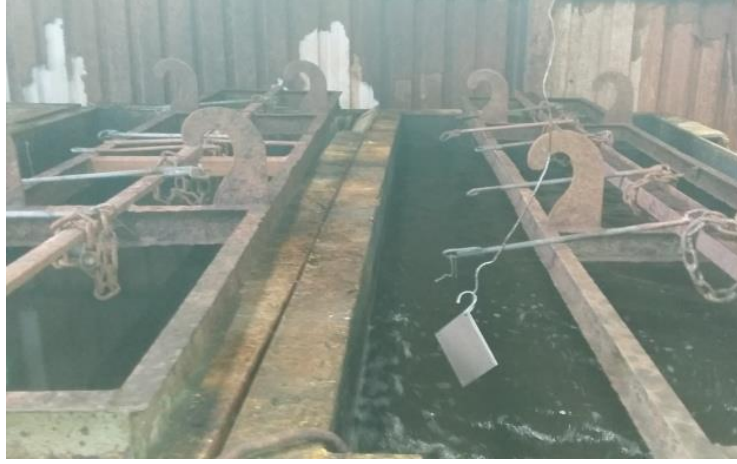
Şekil 3.6: 1. grup deneylerden daldırma/çekme açısı 180^{\circ} iken numune sacın flux banyosuna dalışı
