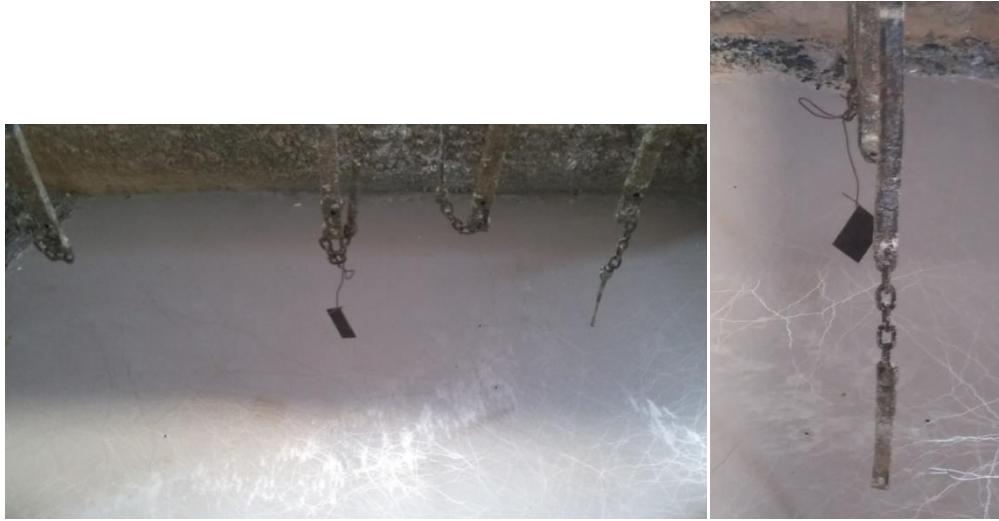
Şekil 4.3: 90 0 daldırma açısında numune sacın çinko kaplama banyosu içerisine girmesi
