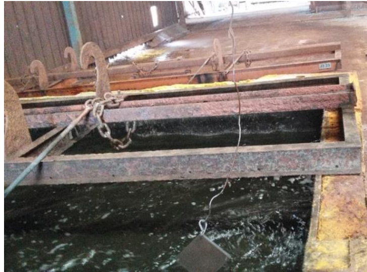
Şekil 3.5: 1. grup deneylerden daldırma/çekme açısı 180^{\circ} olduğunda numune sacın su havuzunda durulanması
