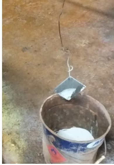
Şekil 3.7: 1. grup deneylerden daldırma/çekme açısı 180^{\circ} iken numune saca nişadır uygulaması
