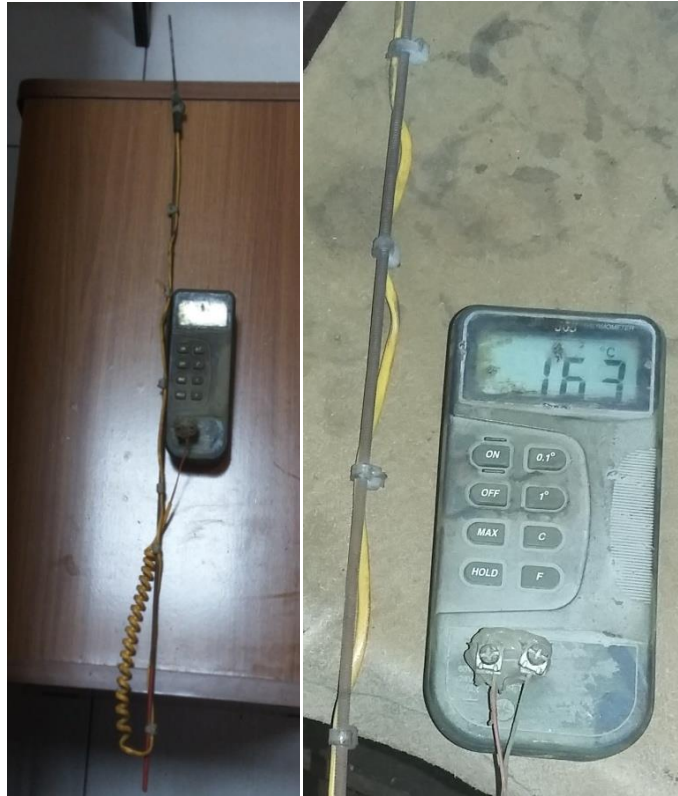
Şekil 3.17: Kaplama banyosunun sıcaklığını ölçmek için kullanılan termometre
