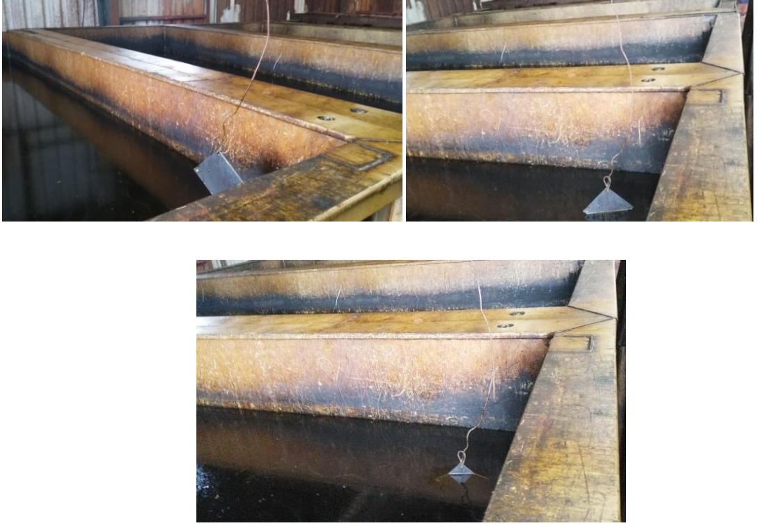
Şekil 3.4: 1. grup deneylerden daldırma/çekme açısı 180^{\circ} iken numune sacın asit banyosuna dalışı ve bekletilmesi
