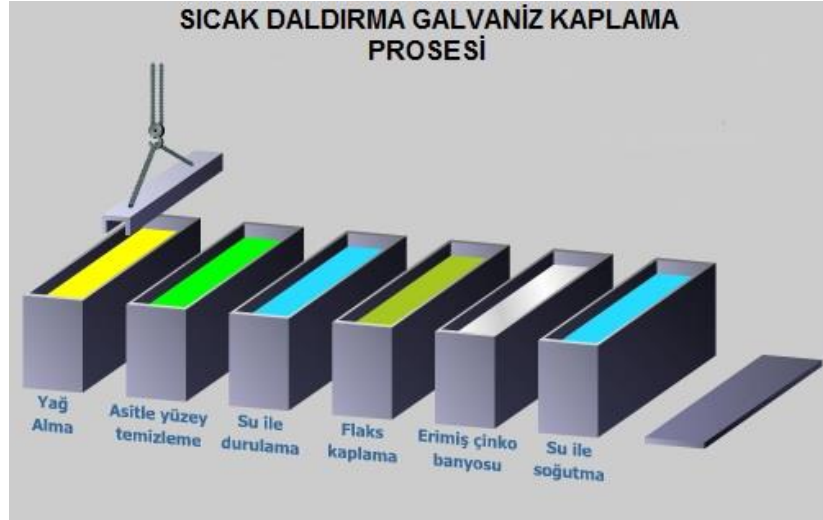
Şekil 2.5: Galvaniz kaplama işlemi uygulama adımları (URL 2)
