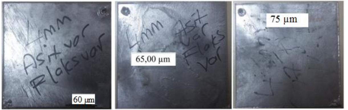
Şekil 4.14: Asit–flux banyolarına daldırılarak galvaniz kaplanan numune sacların görüntüleri
