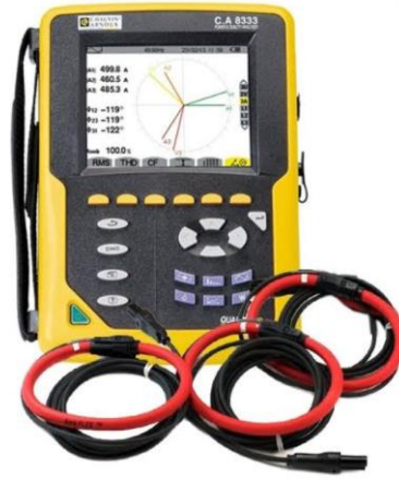
Şekil 5.2: Harmonik analizi için kullanılan Güç Kalite Analizörü
