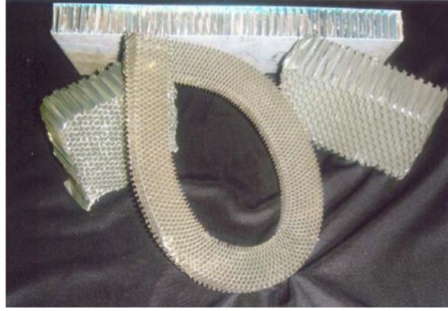
Şekil 2.5: Tamamen alüminyum petek ve alüminyum yüzey tabakalardan üretilmiş sandviç yapı örnekleri (Ercan 2006).
