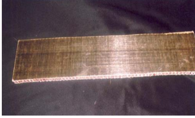
Şekil 2.11: Prepreg ve kevlardan oluşan bal peteği kompozit malzeme (Ercan 2006).
