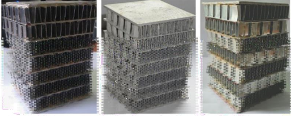
Şekil 1.17: Deneyselerde kullanılan çok katlı bal peteği numuneler (Kılıçaslan ve diğ. 2014).
