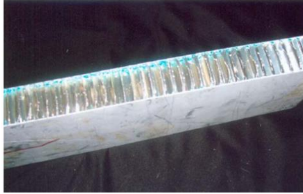
Şekil 2.12: Isıtılmış basınç altında üretilmiş metal tabaka, alüminyum petek hücreden oluşan balpeteği kompozit malzeme (Ercan 2006).
