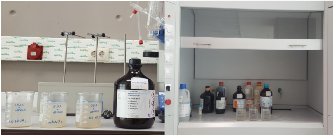
Şekil 16: Sığla yağının hekzanda çözünen formu 3 beher içerisinde, beherler çeker ocak kabininde hekzanın buharlaşma aşamasında
