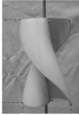
Şekil 4.11. Sarmal Savonius çark profili
