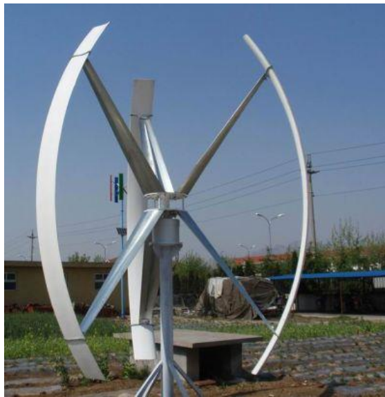
Şekil 3.6. Darrieus tipi düşey (dikey) eksenli rüzgar türbinleri (Özkılınç 2010)
