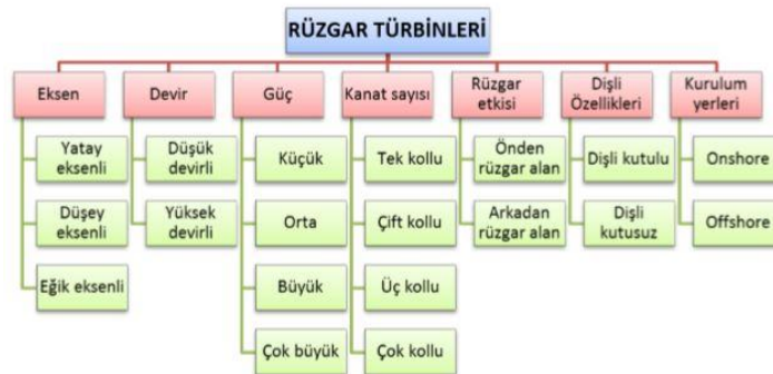
Şekil 3.4. Rüzgar türbinlerinin sınıflandırılması (Leblebicioğlu, 2019)
