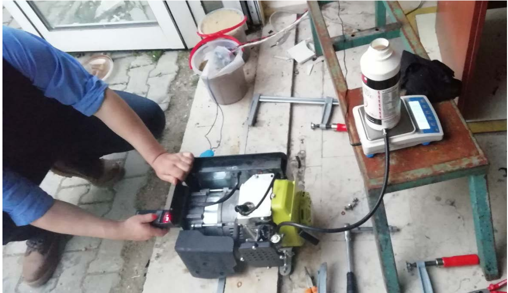
Şekil 4.14: Motor test işlemi sırasında motor devrinin ölçülmesi
