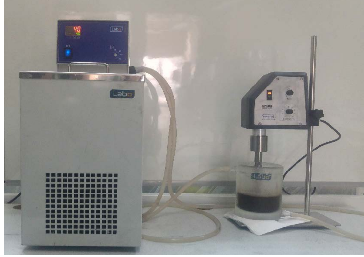
Şekil 4.6: Ultrasonik karıştırıcı ve soğutucu ünite
