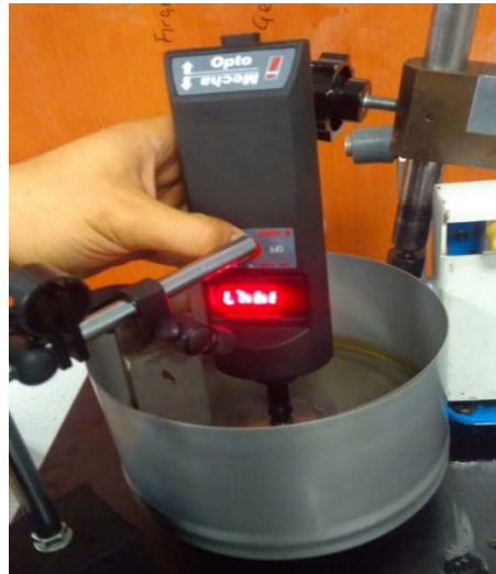
Şekil 4.10: Manuel devir ölçüm takometresi
