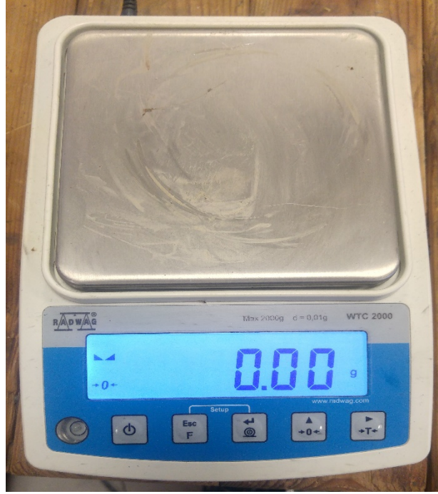
Şekil 4.13: Motor testinde anlık yakıt ölçümünde kullanılan terazi
