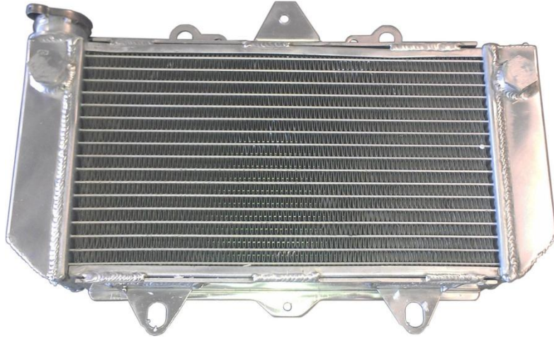
Şekil 5.2: Motosikletlerde kullanılan kanatçıklı levhalı tip ısı değıştircilerine örnek
