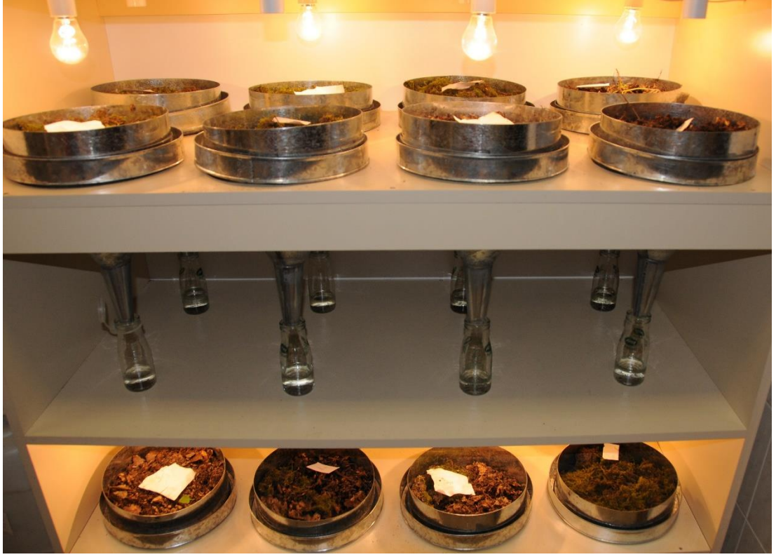
Şekil 3.2: Ayıklama cihazına yerleştirilen döküntü, toprak ve yosun örnekleri.
