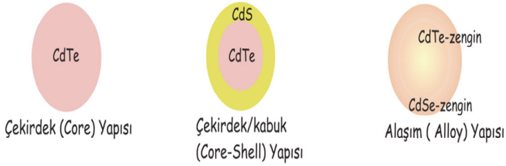
Şekil 3.8.1: Çekirdek/kabuk yapısına sahip nanomalzeme [Baslak, 2014].
