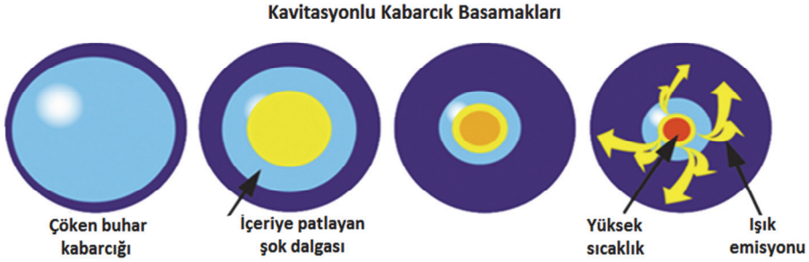
Şekil 2.3.4. Akustik enerjinin ışık enerjisine dönüşümü
