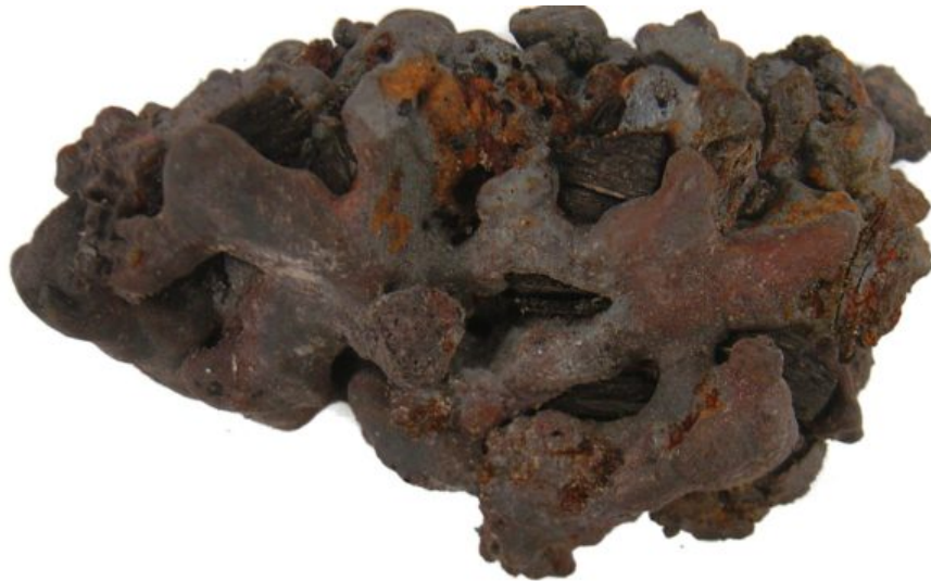
Şekil.3.4: Akma yapısı gösteren bir ergitme cürufu
