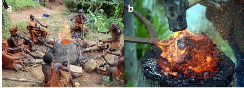
Şekil 2.7: Günümüz ilkel Afrika kabilelerinde metal üretimi a) Ergitme işlemi b) Luppe
