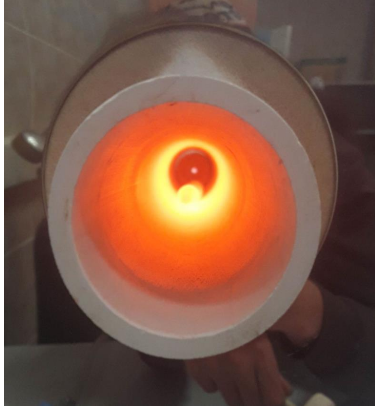
řekil 3.2: 1100°C sıcaklıęında fırın ierisindeki kuvars tp.
