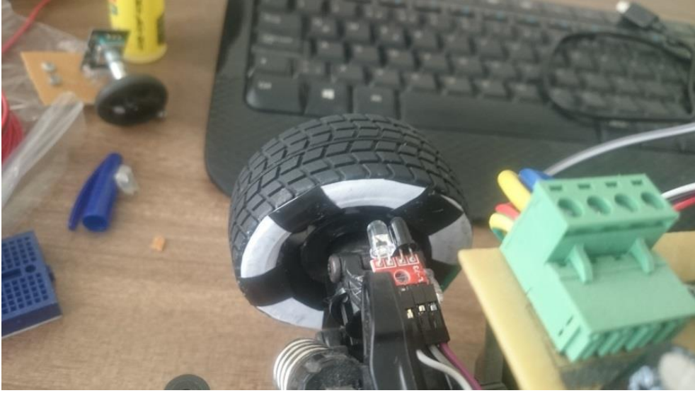
Şekil 2.8: Tekerleğe Yerleştirilen Siyah – Beyaz Şeritler ve Renk Sensörüne Ait Görsel
