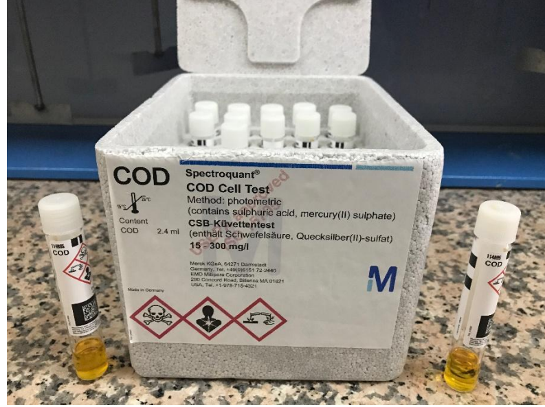
Şekil 3.10: KOİ testlerinde kullanılan test kitleri
