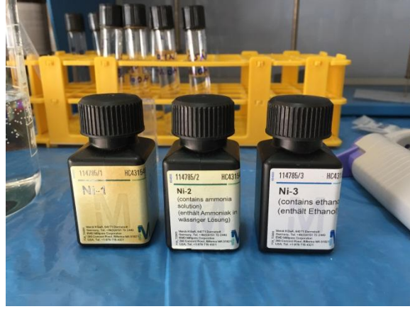
Şekil 3.8: Nikel konsantrasyon ölçümleri için kullanılan kitler
