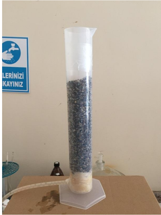
Şekil 3.13: Akü sanayi atıksuyuna ön filtreleme işleminin yapıldığı kum filtre
