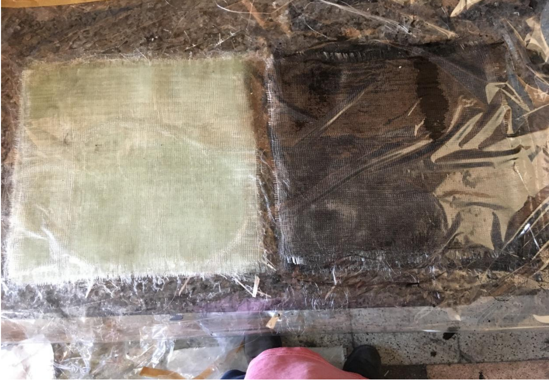
Şekil 3.4: Epoksi emdirilmiş kumaşların sıcak preslemeye hazırlanması.
