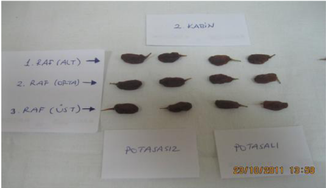
Şekil 7.59: Doğrudan ortam havası sisteminde kurutulan numuneler
