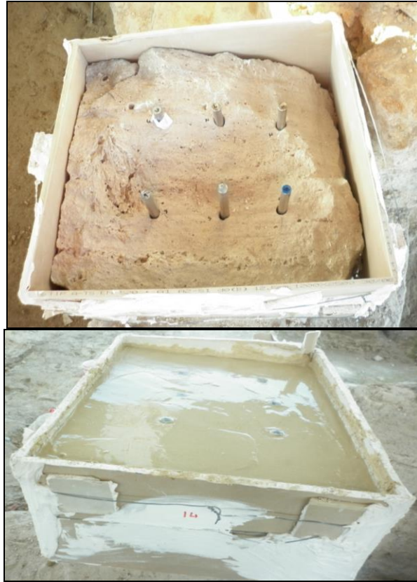
Fig. 60: Harç Karışımı Kalıplar Hazırlanarak Dökümünün Yapılması
