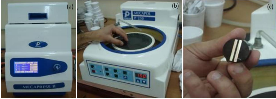
Şekil 3.11. Kesilecek numuneleri bakalite alma makinesi a) Parlatma diskleri b) Bakalite alınmış hali c)
