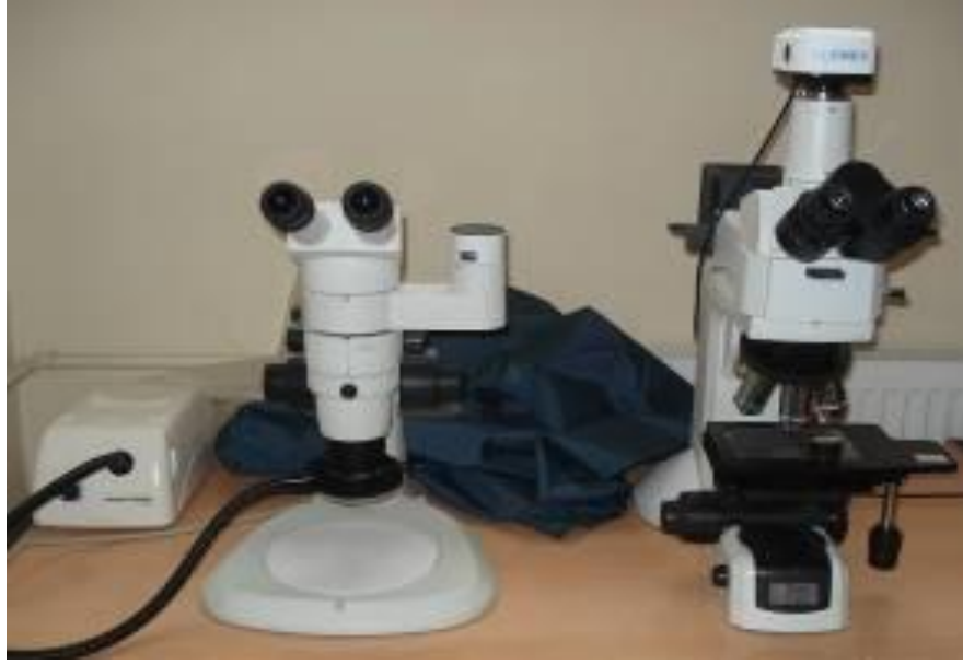
Şekil 3.13. İç yapı incelemesinde kullanılan mikroskoplar.
