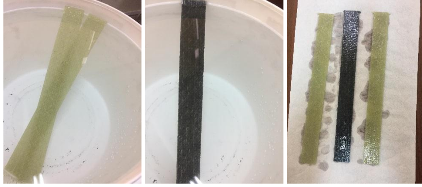
Şekil 4.10: Su emme davranışı için numunelerin hazırlanması
