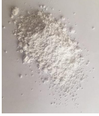
Şekil 2.5: Katkılı plakada kullanılan SiO 2 nano partikül tozu
