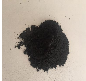
Şekil 2.6: Katkılı plakada kullanılan grafen nano partikül tozu
