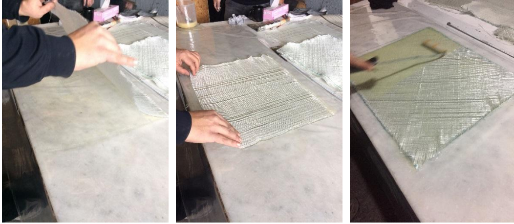
Şekil 3.4: Rulolama işlemi ve elyaf yatırma
