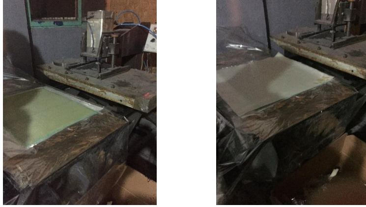
Şekil 3.5: Kompozit plakaların presleme işlemi
