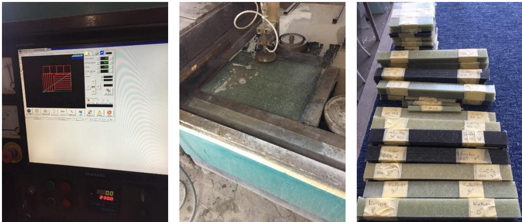
Şekil 3.7: Kompozit plakaların su jeti ile kesimi ve sınıflandırılması
