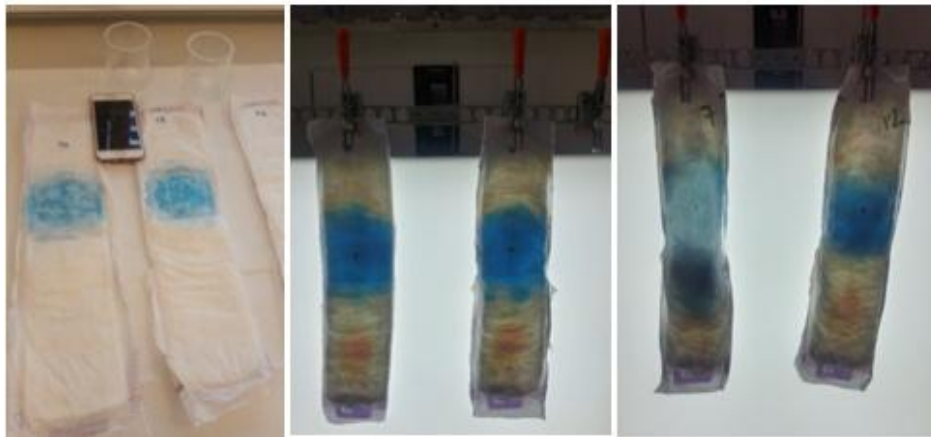
Şekil 6.20: Emici bölge sağlamlık testi uygulama görüntüleri
