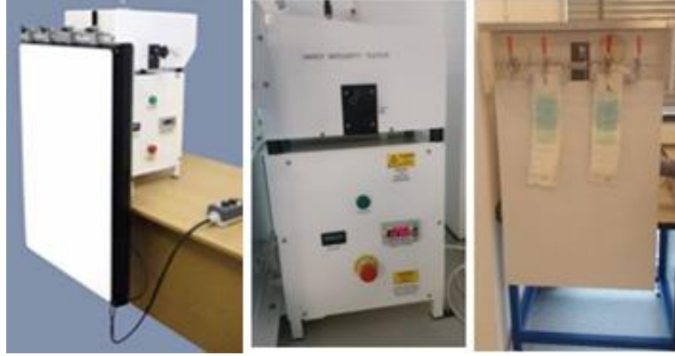
Şekil 6.19: “Hardy Integrity Tester “ emici bölge sağlamlık testi cihazı
