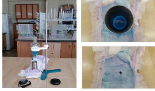
Şekil 6.11: Emme zamanı test düzeneği
