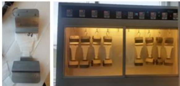
Şekil 6.17: Parçaların çenelere yerleştirilip “statik yük askılı kopma cihazı”na asılması
