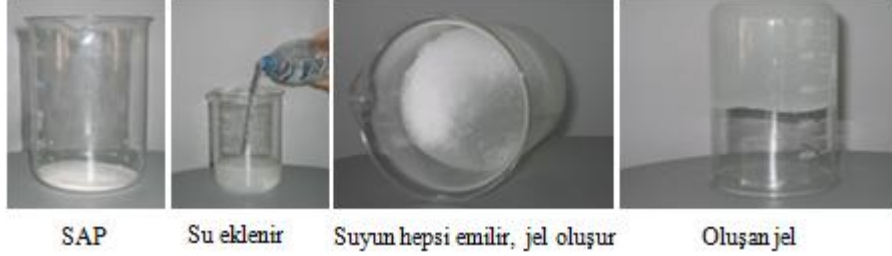
Şekil 2.15: SAP'in su ile reaksiyonu (WEB_18)
