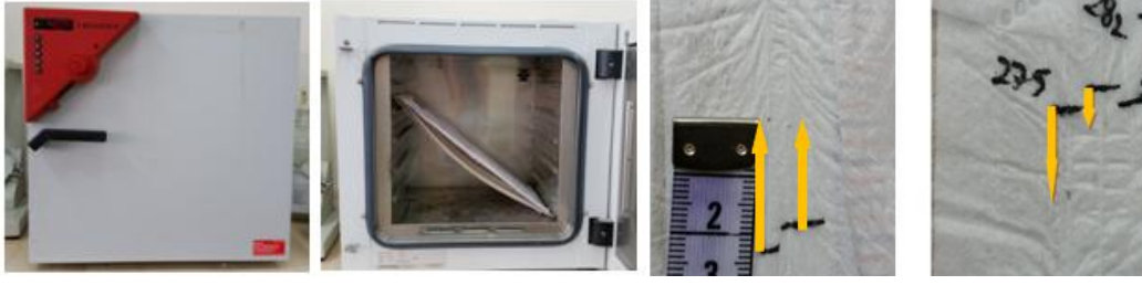
Şekil 6.16: Etüv ve lastiklerde oluşan yürüme görüntüleri
