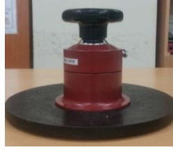
Şekil 6.4: SDL Atlas Martindale pilling cihazının kesim aparatı
