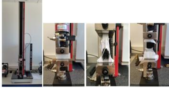
Şekil 6.18: "Zwick" dinamik yük altında kopma cihazı ve test görüntüleri
