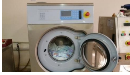
Şekil 6.9: Wascator FOM71 CLS çamaşır makinesi
