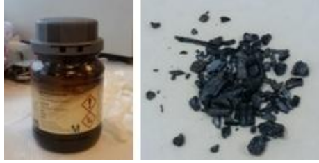
Şekil 6.22: Yapıştırıcı uygulamalarının görüntülenmesinde kullanılan iyot
