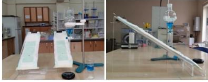
Şekil 6.14: Sıvı akış miktarı tayininde kullanılan düzenek
