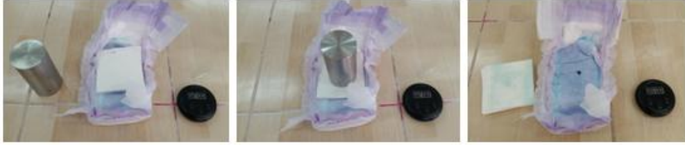
Şekil 6.12: Geri ıslatma miktarı testinde uygulanan adımlar
