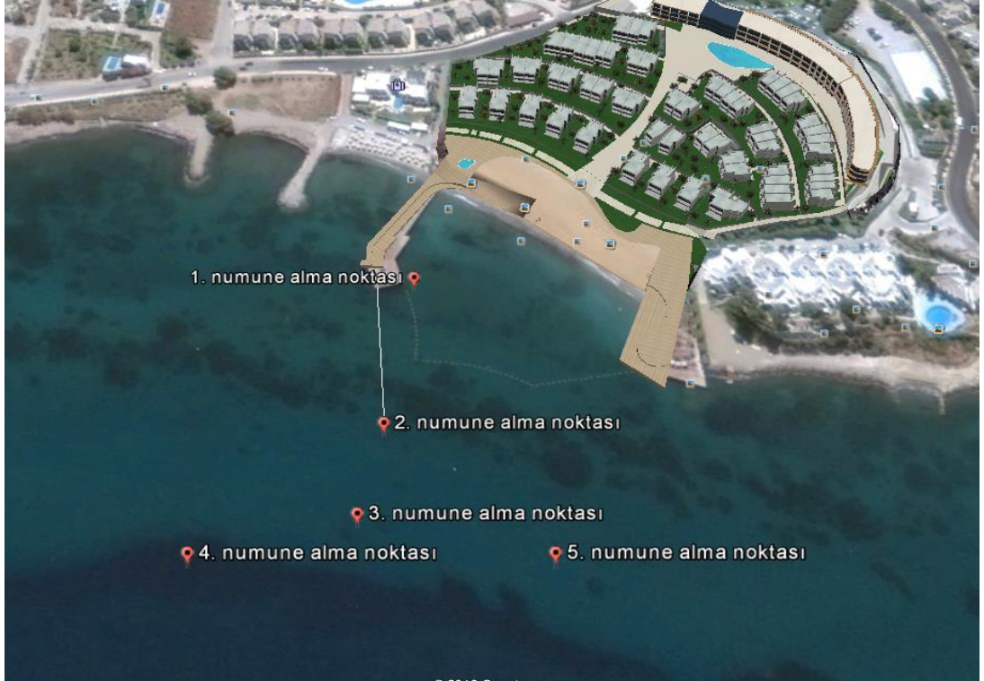
Şekil 5.12: Tesis 3 için ters ozmos tesisi konsantre atıksularının deşarj noktası, koruma bandı ve ölçüm yapılan noktaların genel görünümü
