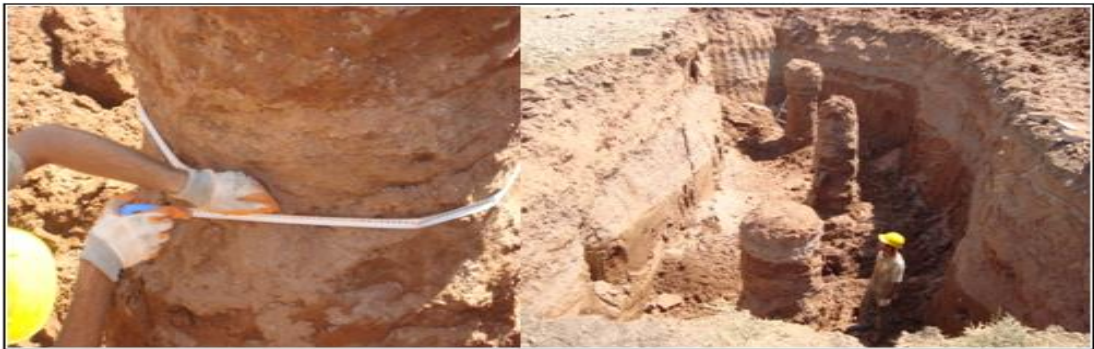
Şekil 4.11: 4-5-6 no'lu test kolonlarının görünümü ve 6 no'lu test kolonunda ölçüm (Anonim 2008 a ).
