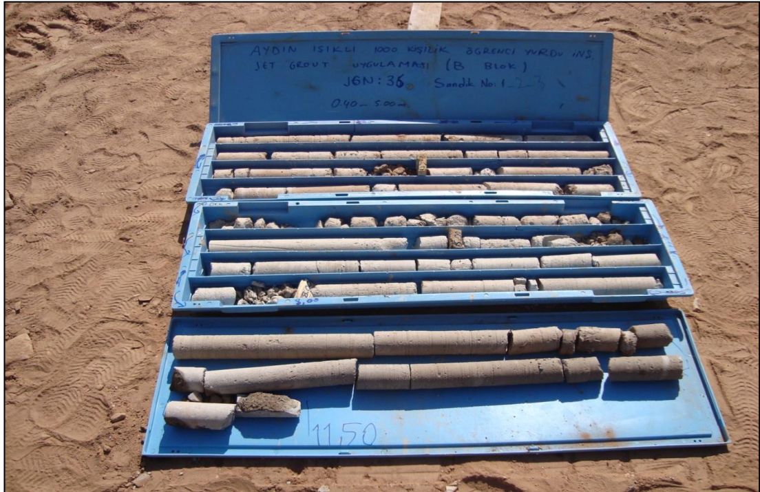
Şekil 4.24: Tam boy süreklilik testi numuneleri (Anonim 2008 a ).
