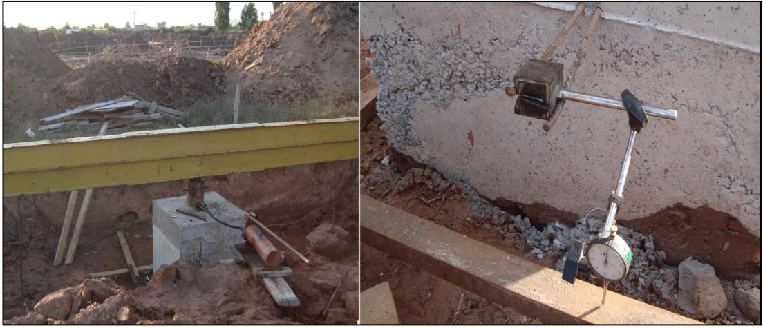
Şekil 4.20: Yükleme testi ve yapılan ölçümler (Anonim 2008 a ).
