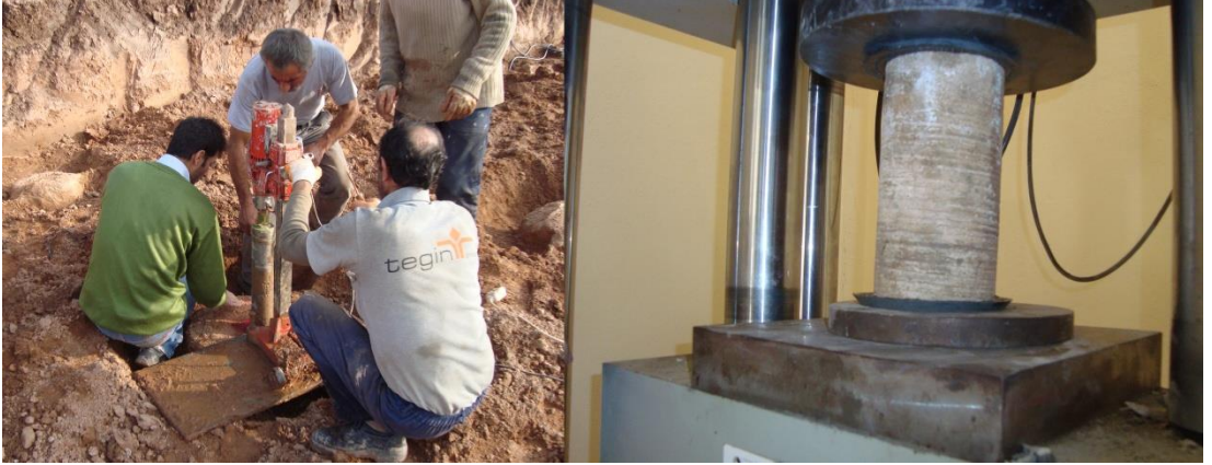
Şekil 2.13: Karot alımı ve basınç deneyi (Anonim 2008 a ).
