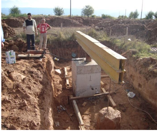
Şekil 2.14: Kolon yükleme deneyi (Anonim 2008 a ).
