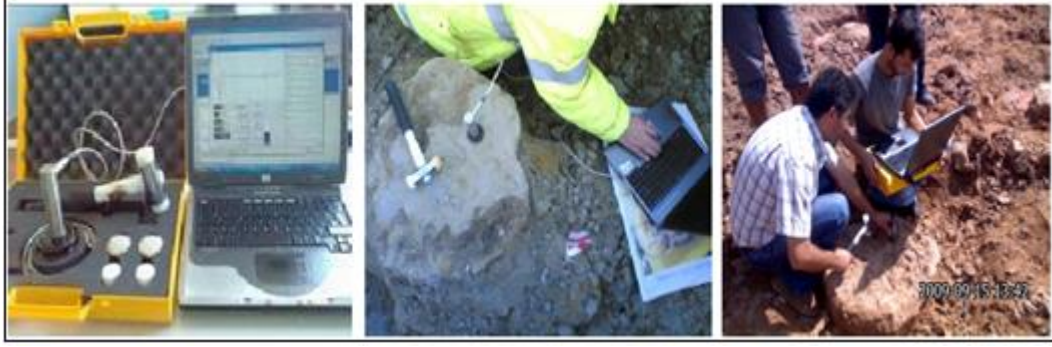
Şekil 2.15: Integrity test ekipmanlarının görünüşü ve testin yapılışı (Anonim 2008 a ).
