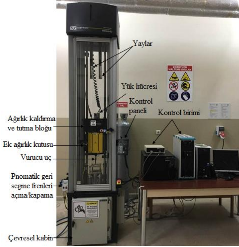
Şekil 4.11: Instron-Dynatup 9250 HV darbe test cihazı
