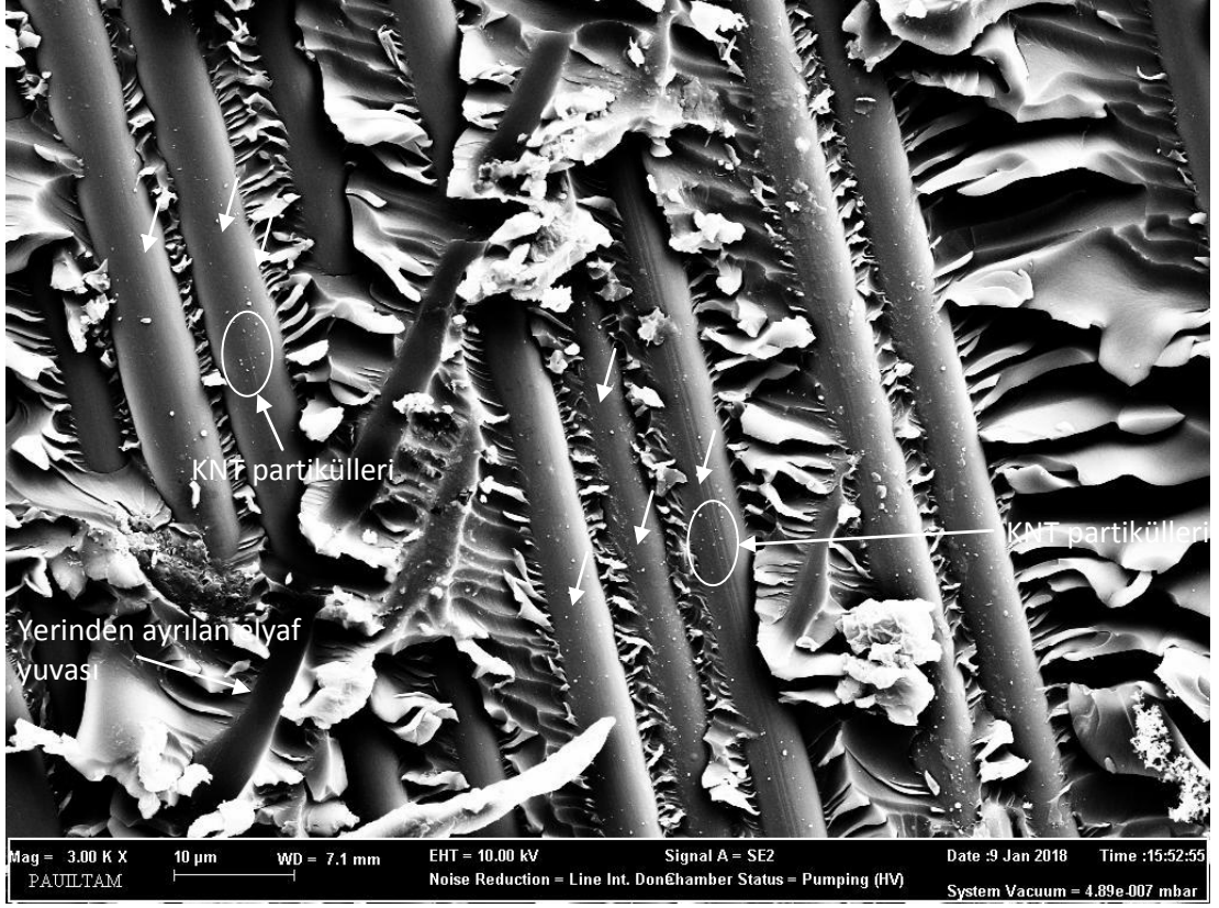
Şekil 4.40: Taramalı elektron mikroskobu (SEM) görüntüsü, tek yönlü dikişsiz kumaş takviyeli karbon/epoksi/KNT
