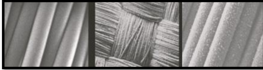
Şekil 1.14: Dokuma poliester kumaşın taramalı elektron mikrografları
