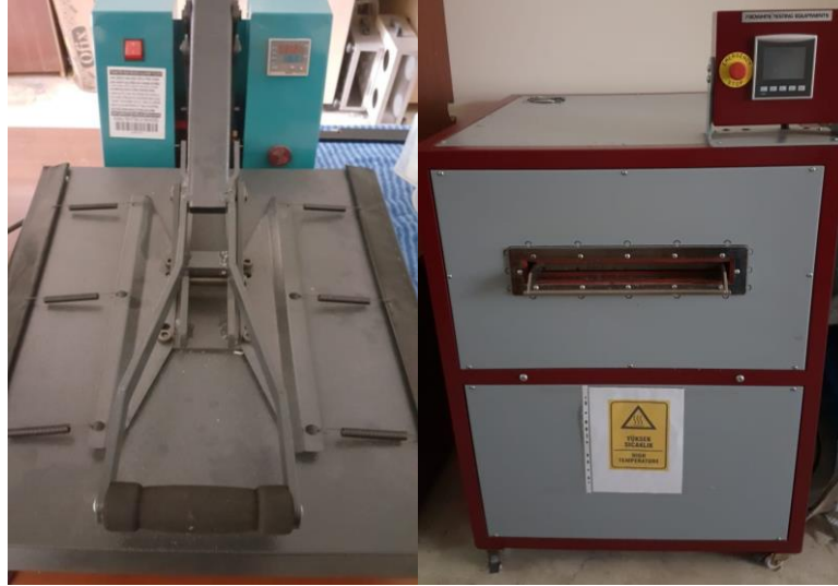
Şekil 3.10: Kurutma ve fikse adımlarında kullanılan makinaların görüntüleri - sıcak pres (solda) / ramöz (sağda)
