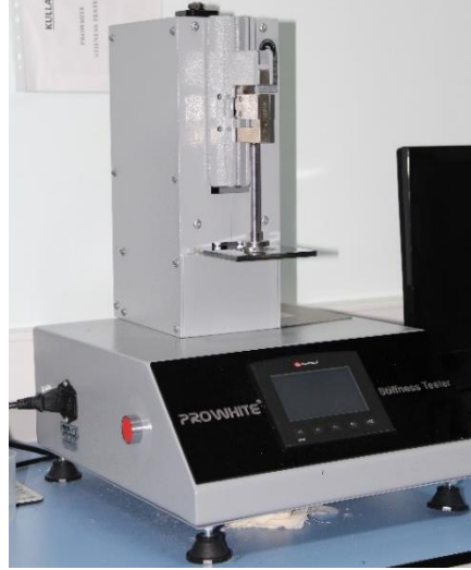
Şekil 3.18: Prowhite Stiffness dijital pnömatik sertlik cihazı
