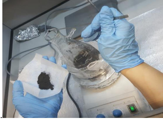
Şekil 3.1: İlk aşama; çözeltiliye grafit eklenmesi
