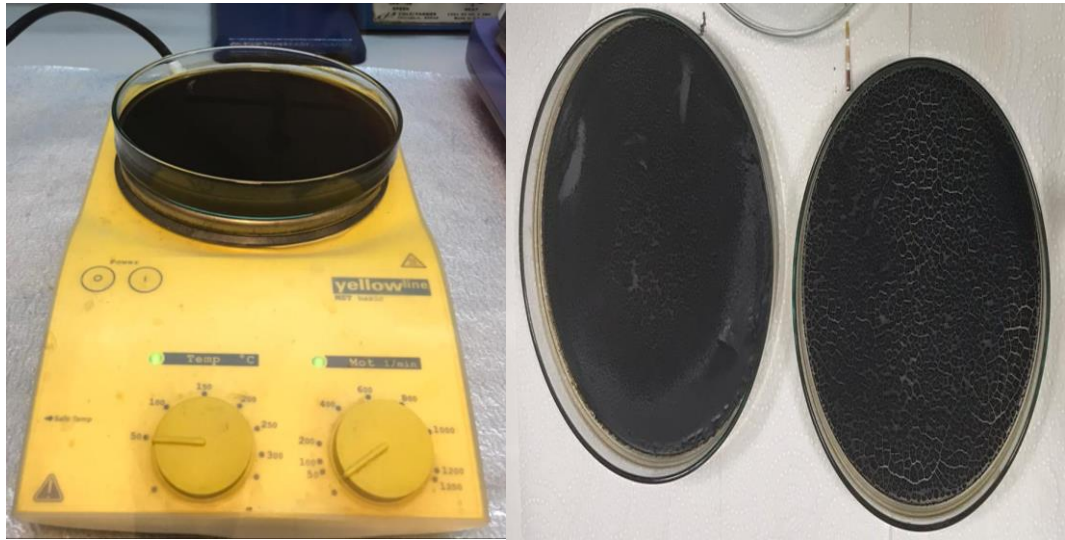
Şekil 3.4: Elde edilen grafen oksitin kurutulması
