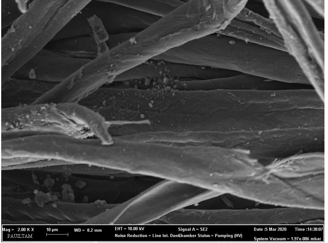
Şekil 7.11: \beta -CD + AgNP + EDTA içeren kumaşa ait 2000x SEM görüntüsü
