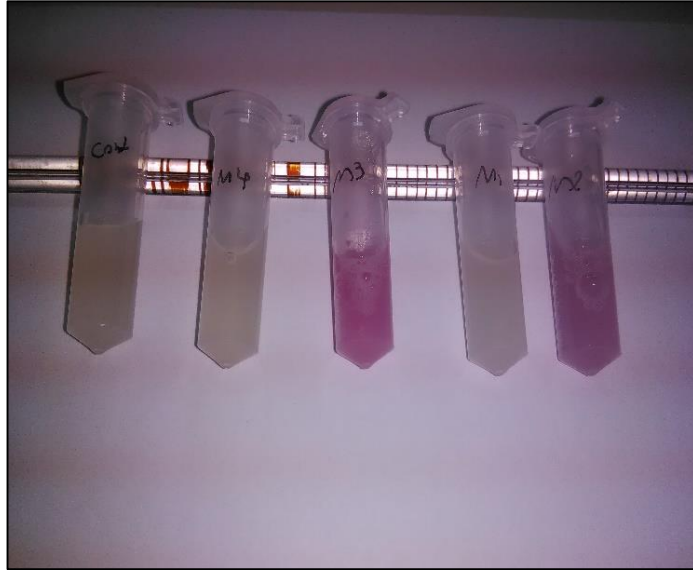
Şekil 4.3. Lakkaz enzimi içeren bakteri izolatu Syringaldazin bulunan ortamda aktivite göstererek pembe rengi oluşturmuştur (Pembe rengin varlığı lakkaz enzimini doğrulamaktadır).
