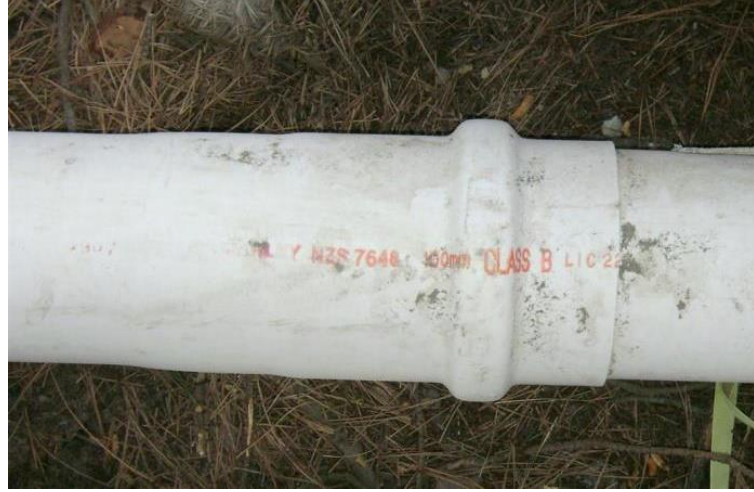
Şekil 3.2: PVC tipi boruda basınç etkisi ile eklem bölgesi hareketi (O'Callaghan 2014)
