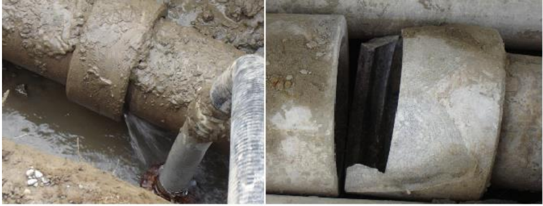
Şekil 3.7: Christchurch Depremi etkisi altında AC tipi boruda meydana gelen çekme (sol) ve basınç (sağ) etkisi (O'Callaghan 2014)
