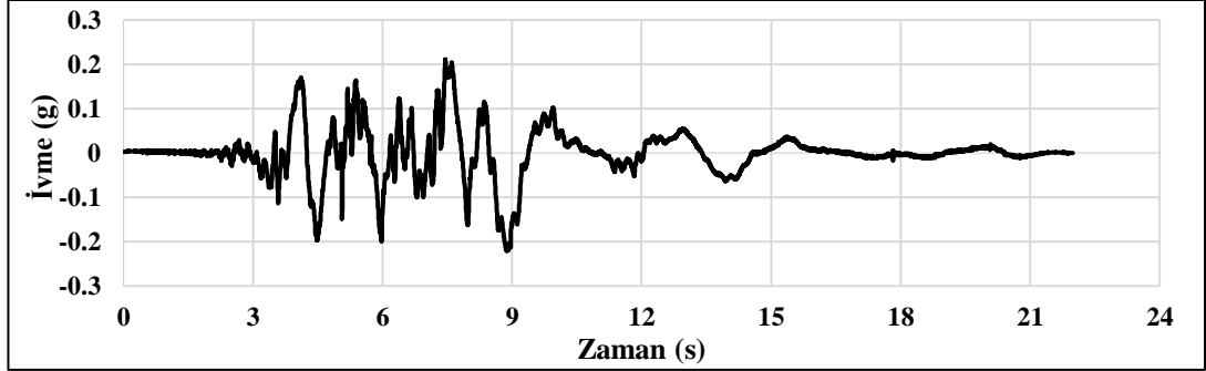
Şekil 5.18: Deepsoil ile CI boru hasarı analizi için model derinliğinde elde edilen ivme-zaman kaydı
