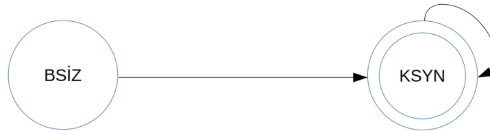
Şekil 4.4: GEHABBK algoritmasında yer alan hasatçı düğümlerin durum değişimlerini gösteren sonlu durum diyagramı.
