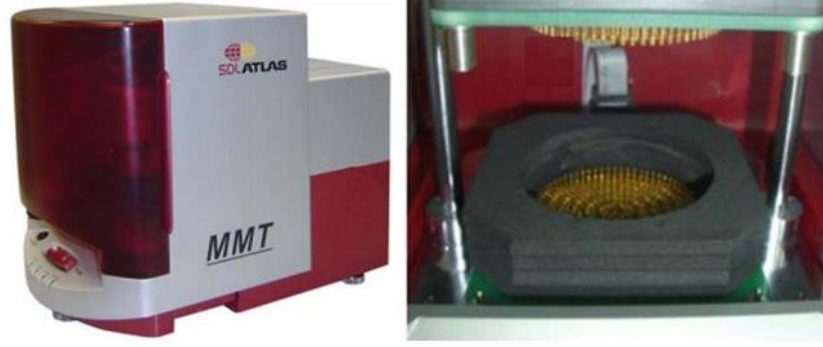
Şekil 2.1: MMT Cihazı a) Genel görünüm b) Alt ve üst sensörler (MMT manuel 2005)
