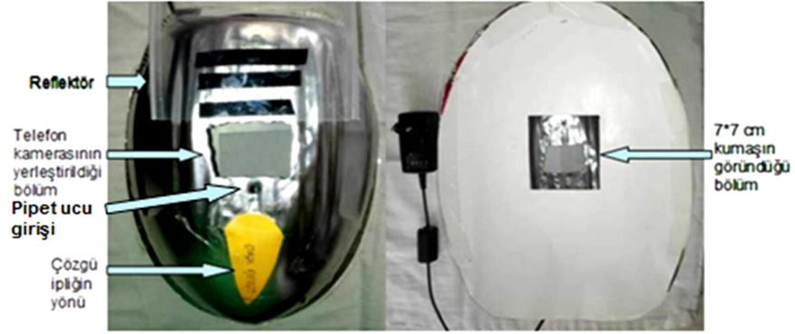
Şekil 4.3: Reflektörün ön ve arkadan görünümü
