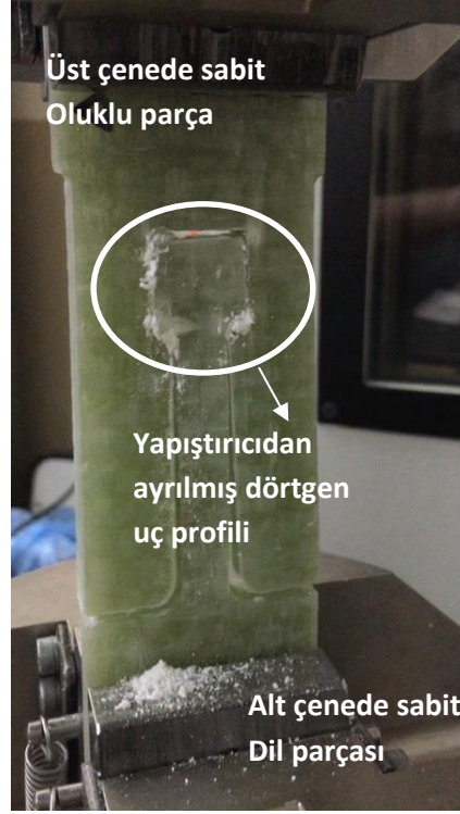
Şekil 4.7: Deney cihazında yapıştırıcı bağlantısı ayrılmış dörtgen uç profilinde numune örneği
