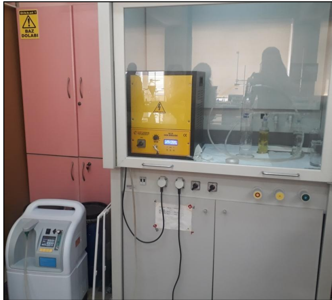
Şekil 2.9: Ozon oksidasyon ve perokson deney düzeneği
