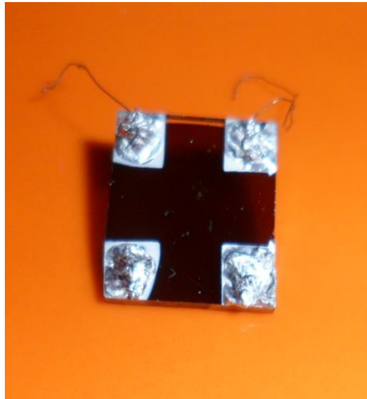
Şekil 3.8 : Van Der Pauw geometrisine göre İndiyum kontak alınmış ince film.
