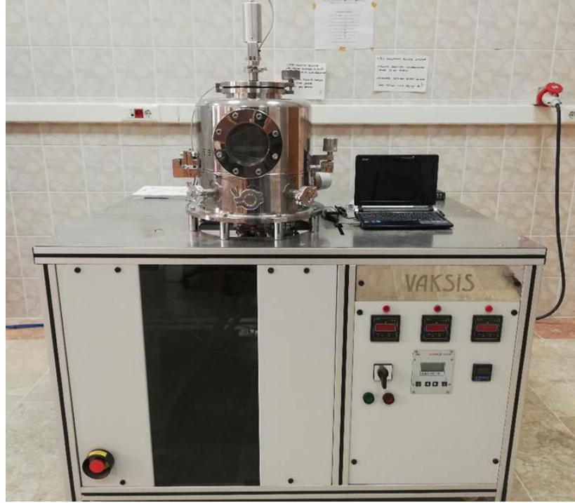
Şekil 3.3 : Termal Buharlaştırma Sistemi (Dıştan görünüş).
