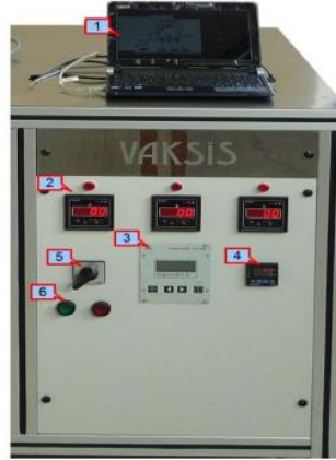
Şekil 3.6: Termal buharlaştırma sisteminin elektronik kabin ünitesi 1) Bilgisayar, 2) Ampermetreler ve termal buharlaştırma güç kaynağı göstergeleri, 3) Turbo pompa kontrol ekranı, 4) Sıcaklık PID kontrol ekranı, 5) Ana şalter, 6) Açma/Kapama anahtarları (Gölcür 2012).
