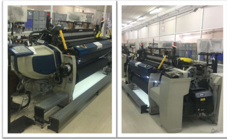
Şekil 5.3: Picanol Dokuma makinesi
