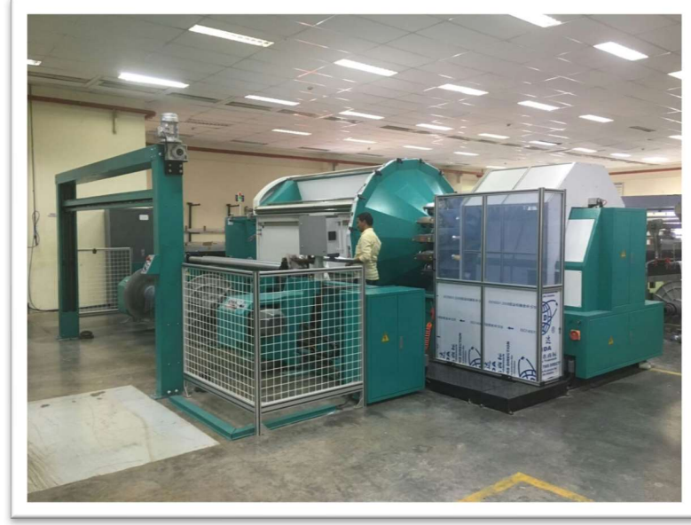
Şekil 5.1: Karl Mayer numune çözgü makinesi
