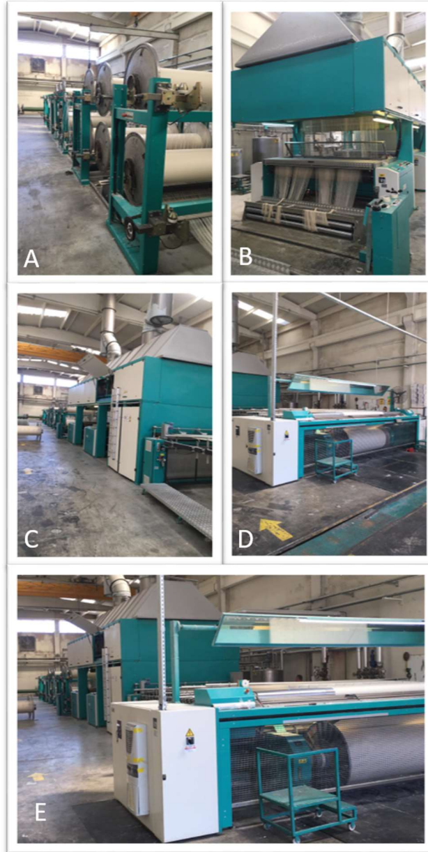
Şekil 2.6: Haşıl makinesi bölümleri A)Levent çağlığı, B)Haşıl tekneleri, C)Kurutma ünitesi, D)Çekim silindiri ve sarım mekanizması, E)Haşıl makinesi genel görünüm
