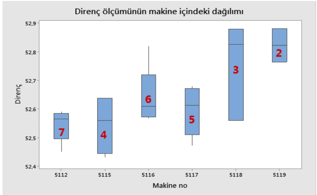
Şekil 5.29: Direnç ölçümünün makine içinde dağılımı
