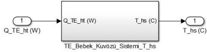
Şekil 4.30: Termoelektrikli kuvöz sisteminin (plant) tek bir Simulink blok diyagramı olarak oluşturulması
