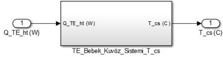
Şekil 4.32: Termoelektrikli kuvöz sisteminin (plant) tek bir Simulink blok diyagramı olarak oluşturulması
