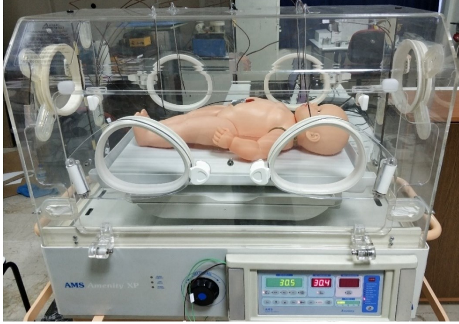
Şekil 6.5: Rezistanslı kuvöz sisteminin model bebekli deney düzeneği
