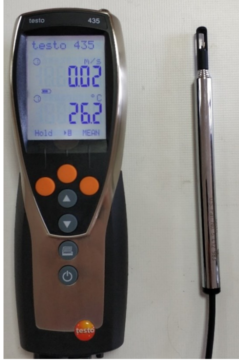
Şekil 5.7: Testo 435-3 çok fonksiyonlu ölçüm cihazı ve Testo 0635-1025 sıcak tel (hot wire) hız ölçüm probu
