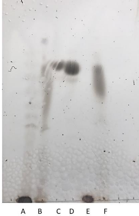
Şekil 3.13: Lactococcus lactis PLAC39 suşu tarafından üretilen GtfB enziminin amiloz, maltodekstrin ve maltoz üzerindeki aktivitelerini gösteren TLC görüntüsü (substratlarının bulunduğu reaksiyon ortamında 37°C, 24 saat inkübasyon sonucunda açığa çıkan ürünlerin TLC görüntüsü, Reaksiyon ortamında 25mM sodyum asetat, 1mM CaCl 2 pH 4.7 A; Maltodekstrin(kontrol), C; Maltoz (kontrol), E; Amiloz (kontrol), B; 25 mM Maltodekstrin D; 25 mM Maltoz, F; %0.125 Amiloz substratları ile oluşturulan enzim-substrat reaksiyonları)
