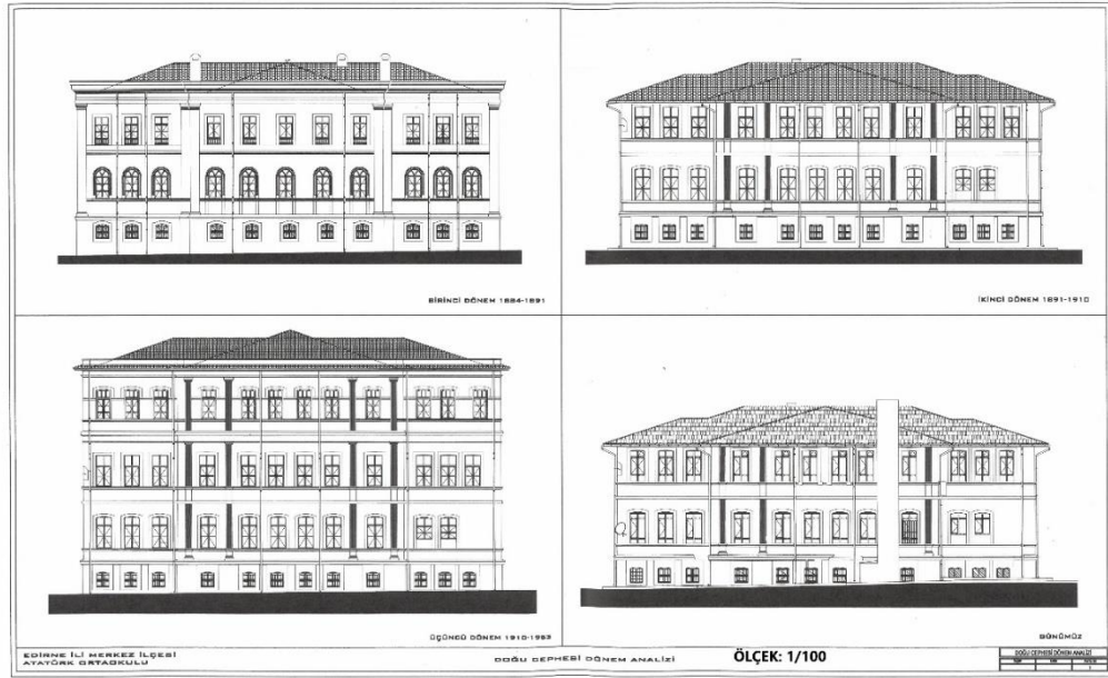
Çizim 54. Edirne İdadisi Doğu Cephe Dönem Analizli Çizimi (Edirne Turizm ve Endüstri A.Ş.)
