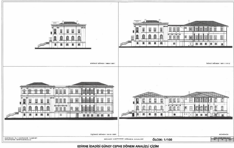
Çizim 55. Edirne İdadisi Güney Cephe Dönem Analizli Çizimi (Edirne Turizm ve Endüstri A.Ş.)
