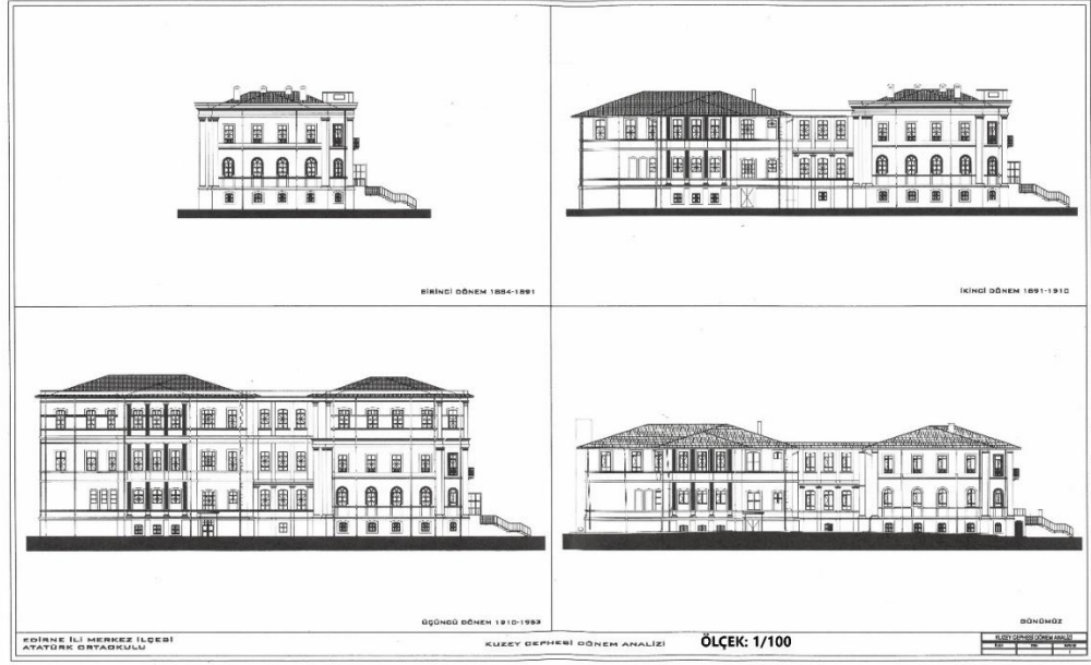
Çizim 56. Edirne İdadisi Batı Cephe Dönem Analizli Çizimi (Edirne Turizm ve Endüstri A.Ş.)
