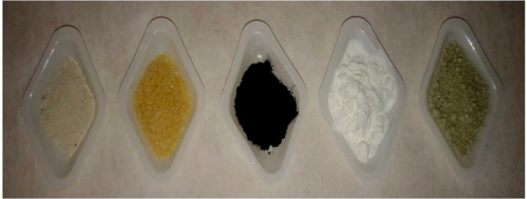
Şekil 2. 1: Kullanılan adsorbentler (soldan sağa; pekmez toprağı, jelatin, aktif karbon, PVP ve bentonit)
