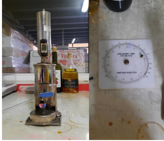
Şekil 2. 14: Etil alkol miktarının belirlenmesinde kullanılan ebülyometre
