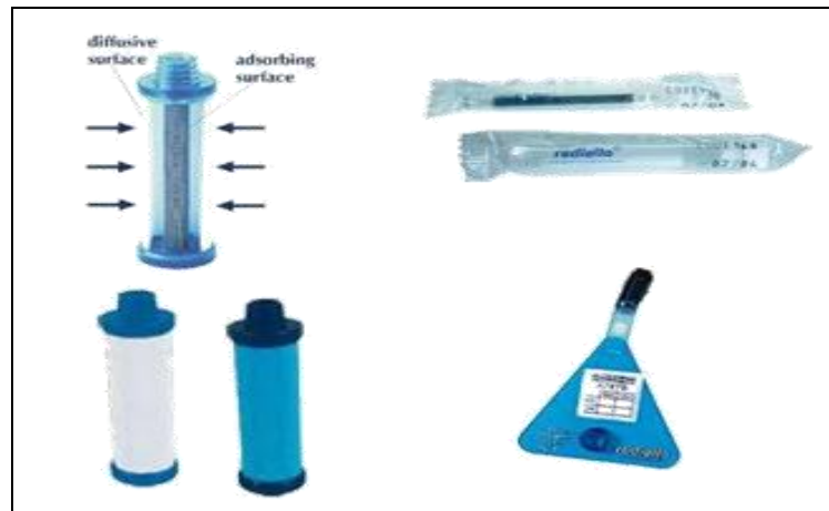
Şekil 3.2: Tez çalışmasında kullanılan Radiello ® pasif örnekleme tüpleri
