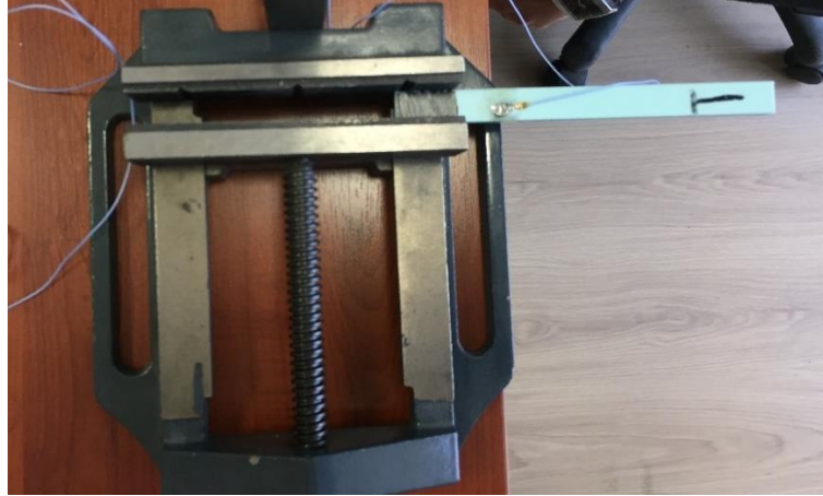
Şekil 5.36: Kirişin Sabitleyiciye Bağlanarak Deney Mekanizmasının Oluşturulması
