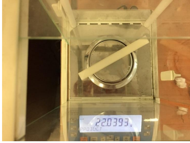
Şekil 5.28: RADWAG (NAS-220/C/2) Hassas Terazisi ve Ana Parçanın Ağırlığının Ölçülmesi
