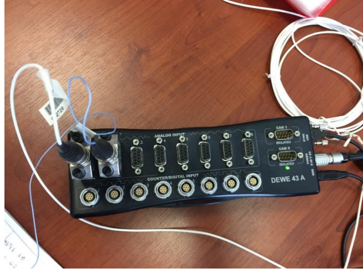
Şekil 5.38: Çalışmada Kullanılan DEWE 43 A Veri Toplama Cihazı ve Bağlantı Kabloları
