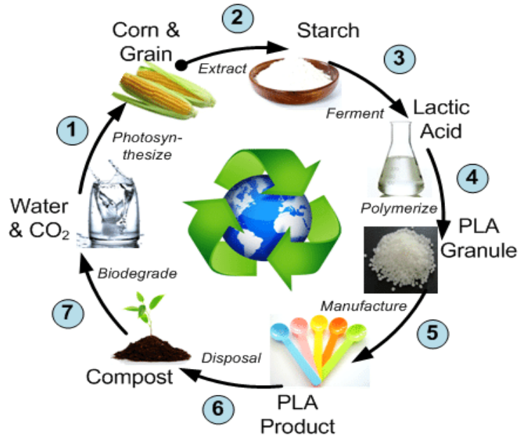
Şekil 4.9: PLA Malzemesinin Üretim ve Dönüşüm Aşamaları (Peng ve Sun, 20107)
