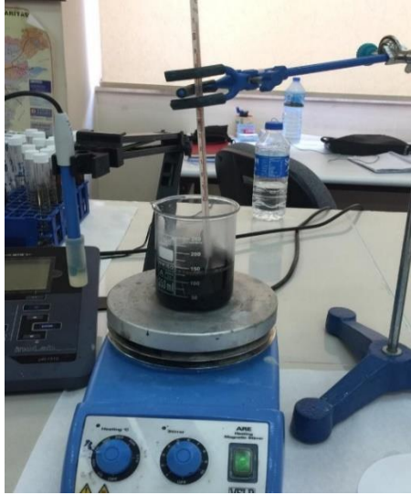
Resim 3.5: Aktif karbon adsorpsiyonu
