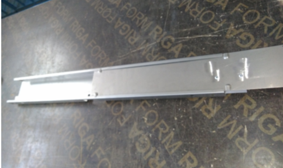
Şekil 7.5: Alın sacı sürgülü montaj
