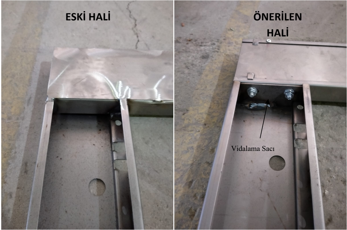
Şekil 7.9: Kasa birleştirme eski hali ve önerilen hali
