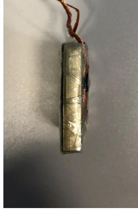
Şekil 4.3: Alıcı bobin ve kalp pili kasa sının yandan görünümü
