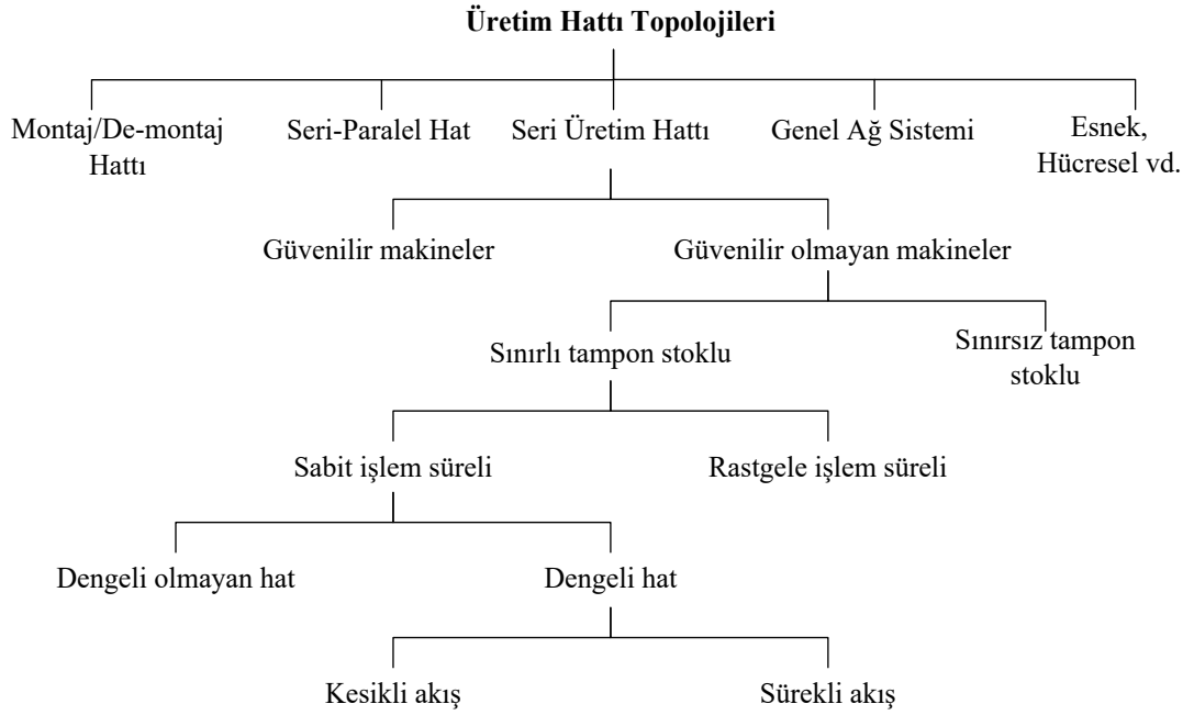
Şekil 2.1: Üretim hatlarının özelliklerine göre sınıflandırılması (Li ve diğ. 2009)
