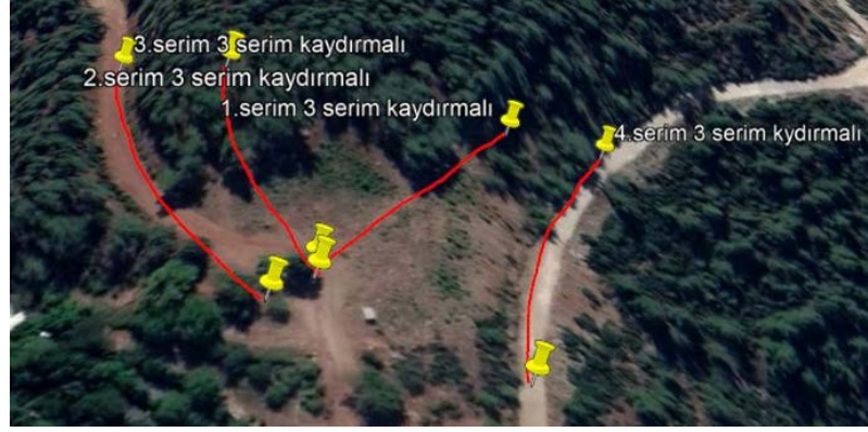
Şekil 7.22: MASW yönteminde ölçü alınan yerlerin arazide gösterimi.
