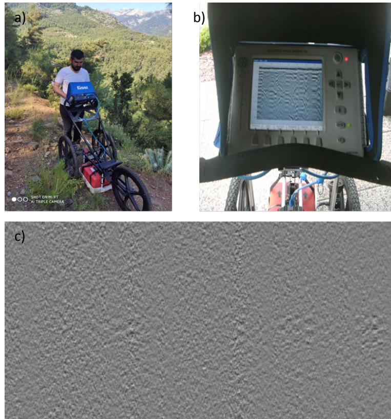
Şekil 7.20: a), b) GPR yönteminin ana bileşenleri ve c) örnek radagram görüntüsü.
