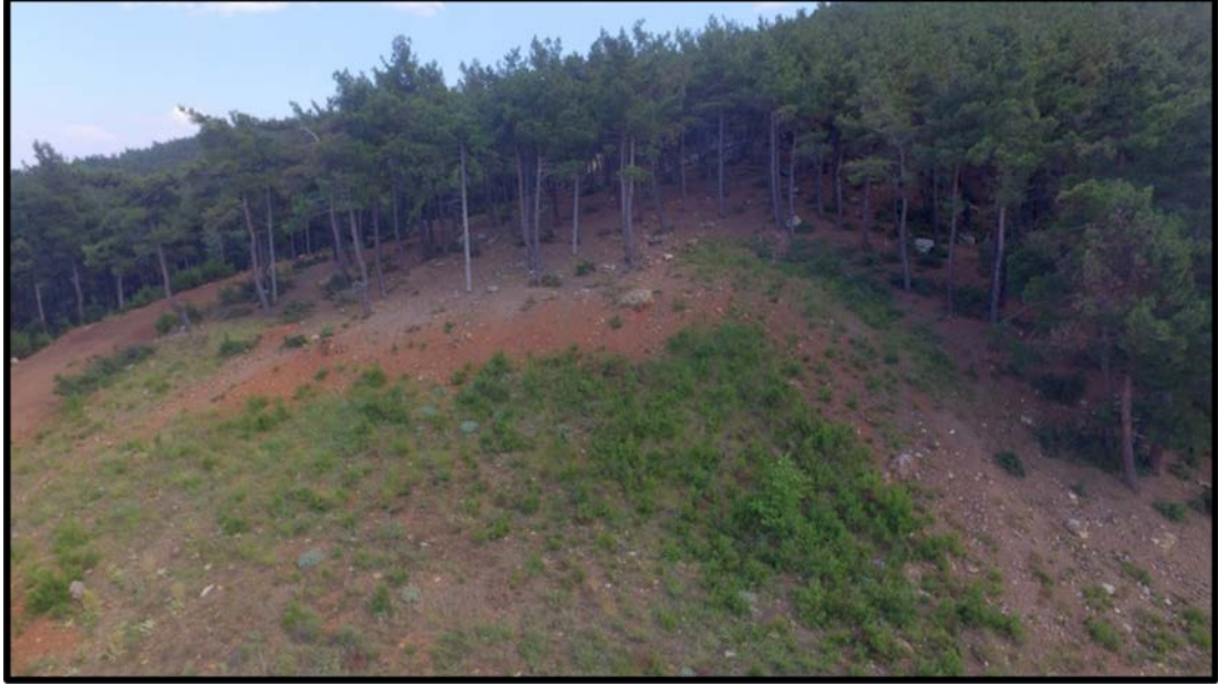
Şekil 7.3: Arazide çekilmiş ağaçların eğim yönünü gösteren hava fotoğrafı.
