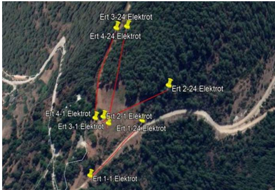
Şekil 7.18: Ç.E.Ö yönteminde ölçü alınan yerlerin arazide gösterimi
