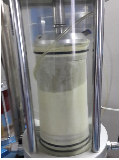
a) Temiz kum numunesinin suya doyurulması işlemi
