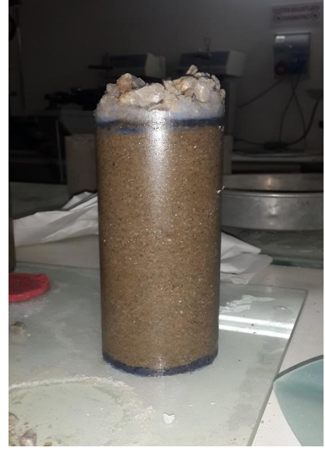
b) %80 rölatif sıklıkta bir numunenin koloidal silika ile iyileştirilmiş hali
