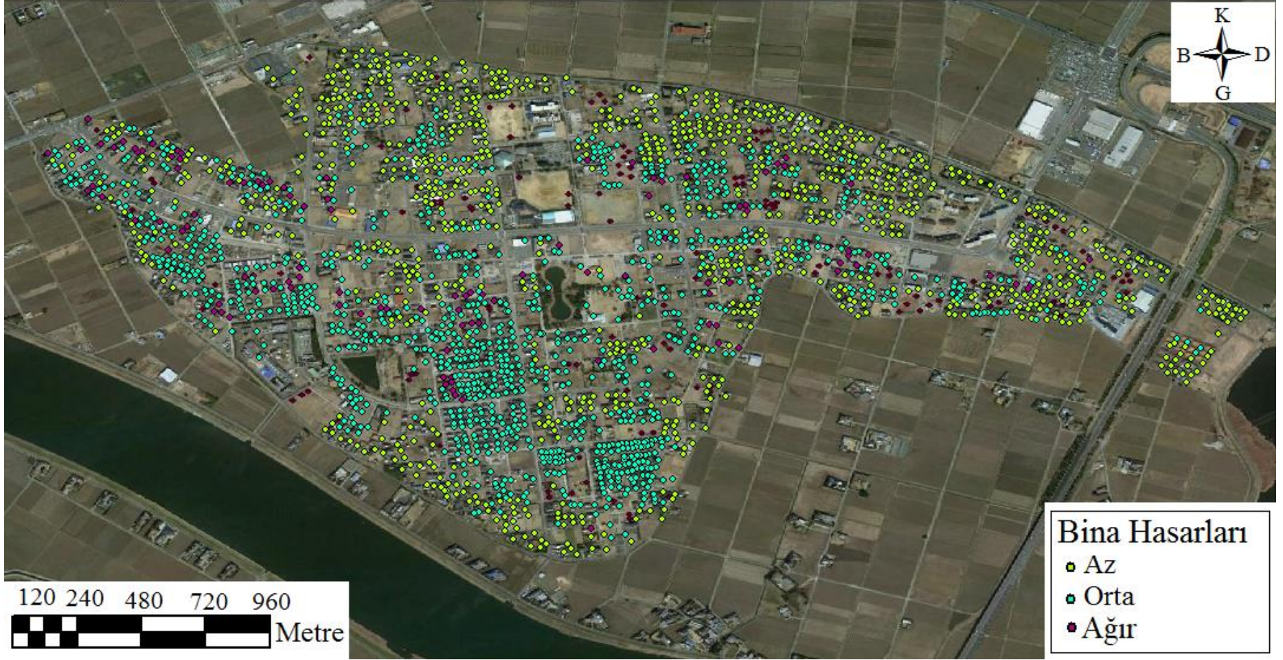
Şekil 3.3: Hinode bölgesi bina hasarları
