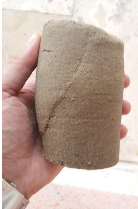
Şekil 4.11: Temiz kum numunesinin deney sonrası görüntüsü
