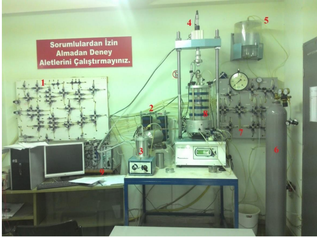
1- Vana ve su dağıtım paneli, 2- Geri ve hücre basınç aleti, 3- Hacim ölçer, 4- Pneumatic actuator, 5- Hava tahliye tankı, 6-CO2 tüpü, 7- Vana ve su dağıtım paneli, 8-Üç eksenli test hücre 9- Veri toplama sistemi ve bilgisayar
