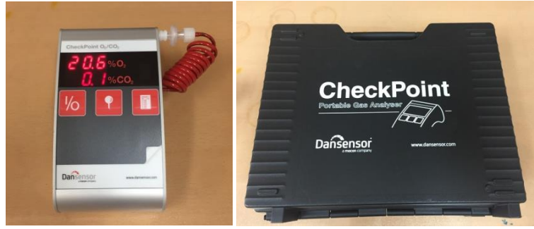
Şekil 2.2: Paket içi gaz atmosferinin belirlenmesinde kullanılan cihaz
